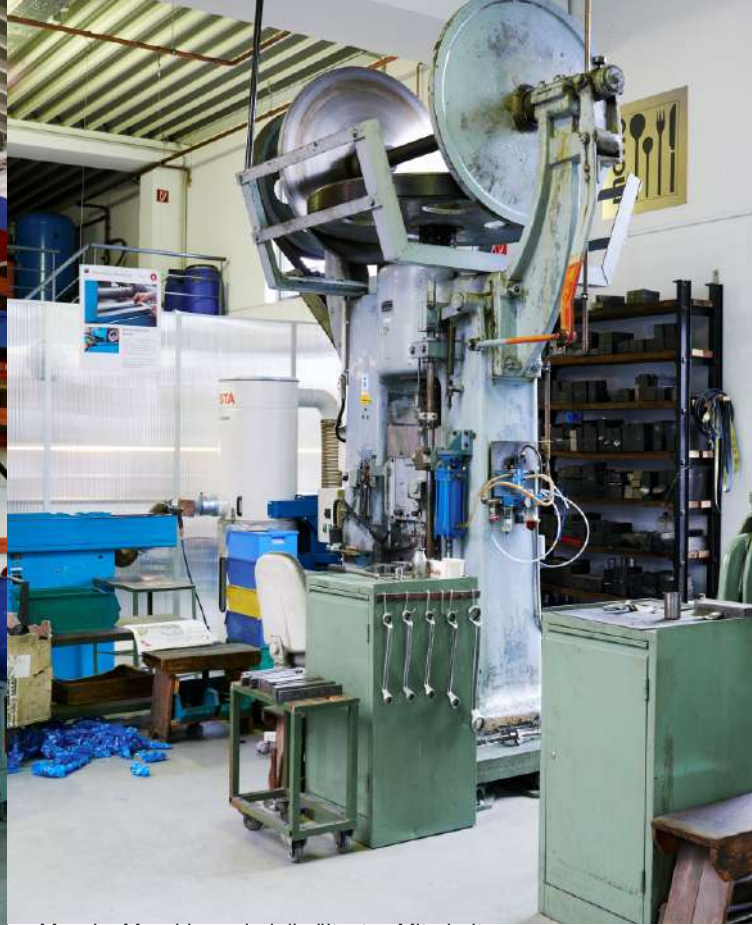
Manche Maschinen sind die ältesten Mitarbeiter. Hier zu sehen eine Spindelpresse von 1958. Some machines are the oldest employees. Here you can see a screw press from 1958.
